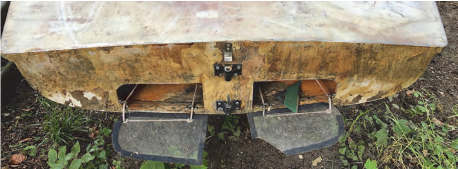
Spiegel und Deck müssen vollkommen erneuert werden
