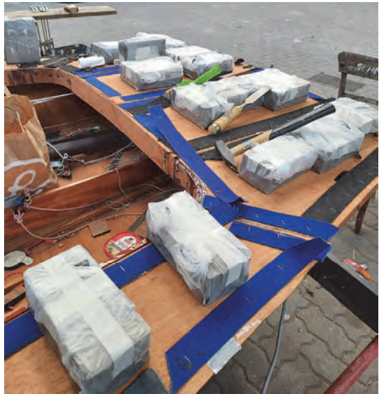
8. Juni: Das neue Deck wird verklebt mit Hilfe von Gurtbändern, Tackern und Gewichtssteinen
